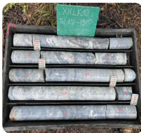
Ảnh. Khoan máy và mẫu lõi khoan đá metacarbonat khu vực Kon Rời, xã KBang, tỉnh Gia Lai
