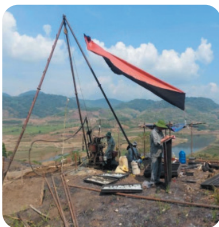
Ảnh. Khoan máy và mẫu lõi khoan đá metacarbonat khu vực Kon Rời, xã KBang, tỉnh Gia Lai
