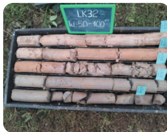
Ảnh. Khoan máy và mẫu lõi khoan diatomit tại khu vực An Xuân
